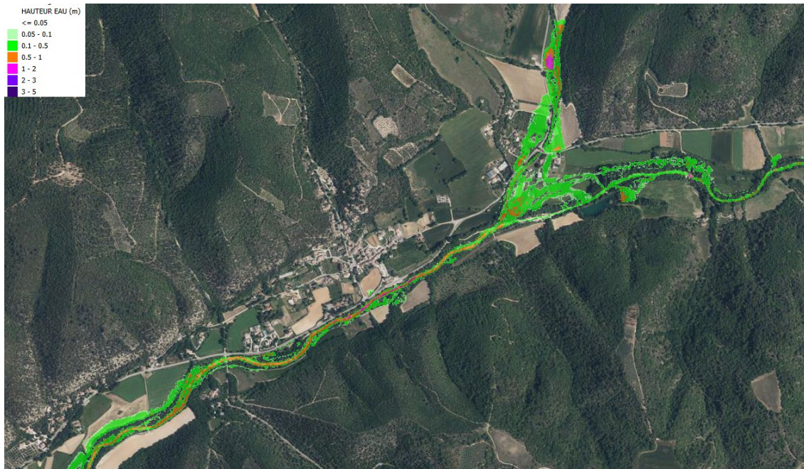
Figure 197 : Cartographie des hauteurs d'eau pour la crue de janvier 2014 (forçage débit_AMC2) : secteur du Castellet
