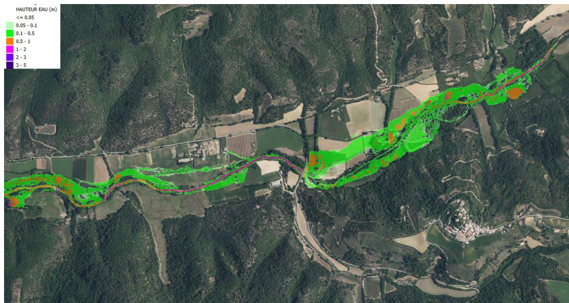
Figure 200 : Cartographie des hauteurs d'eau pour la crue de janvier 2014 (forçage débit_AMC3) : secteur du gué de la route d'Entrevennes
