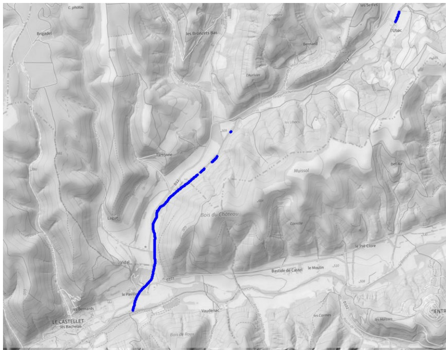
Figure 144 Zones de débordement préférentiel sur le Puimichel, identifiées par l'analyse des écoulements pour la crue issue de l'analyse bivariable des pluies BivP100 sur fonds actuel.
