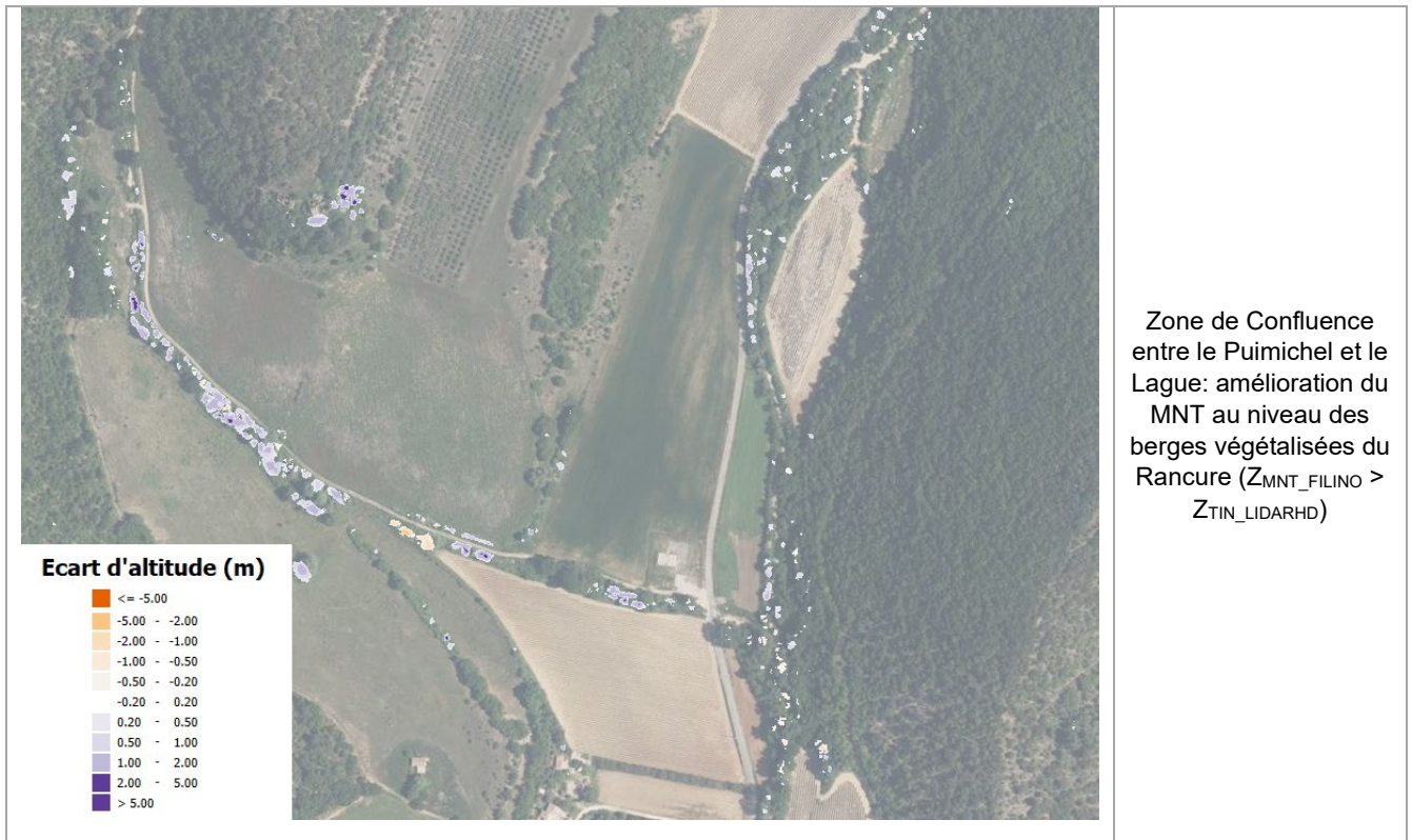
Figure 152 Différence d'altitude entre le MNT issu du traitement FILINO et le mNT issu d'une interpolation TIN uniquement à partir des points « sol » du LIDAR HD
