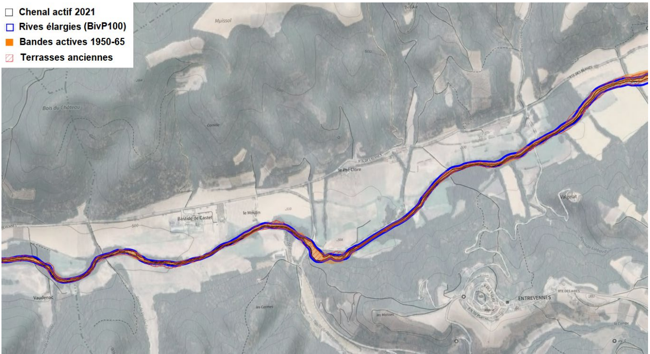
Figure 218 : Élargissement médian simulé du chenal actif (crue BivP100) : secteur du gué de la route d'Entrevennes
