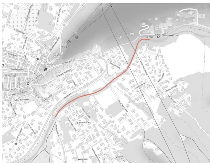
Figure 141 Zones où le rapport entre le débit capacitif du corridor alluvial et le débit sollicitant issu de l'analyse bivariée des pluies BivP100 est supérieur à 1 mais avec une faible marge.
