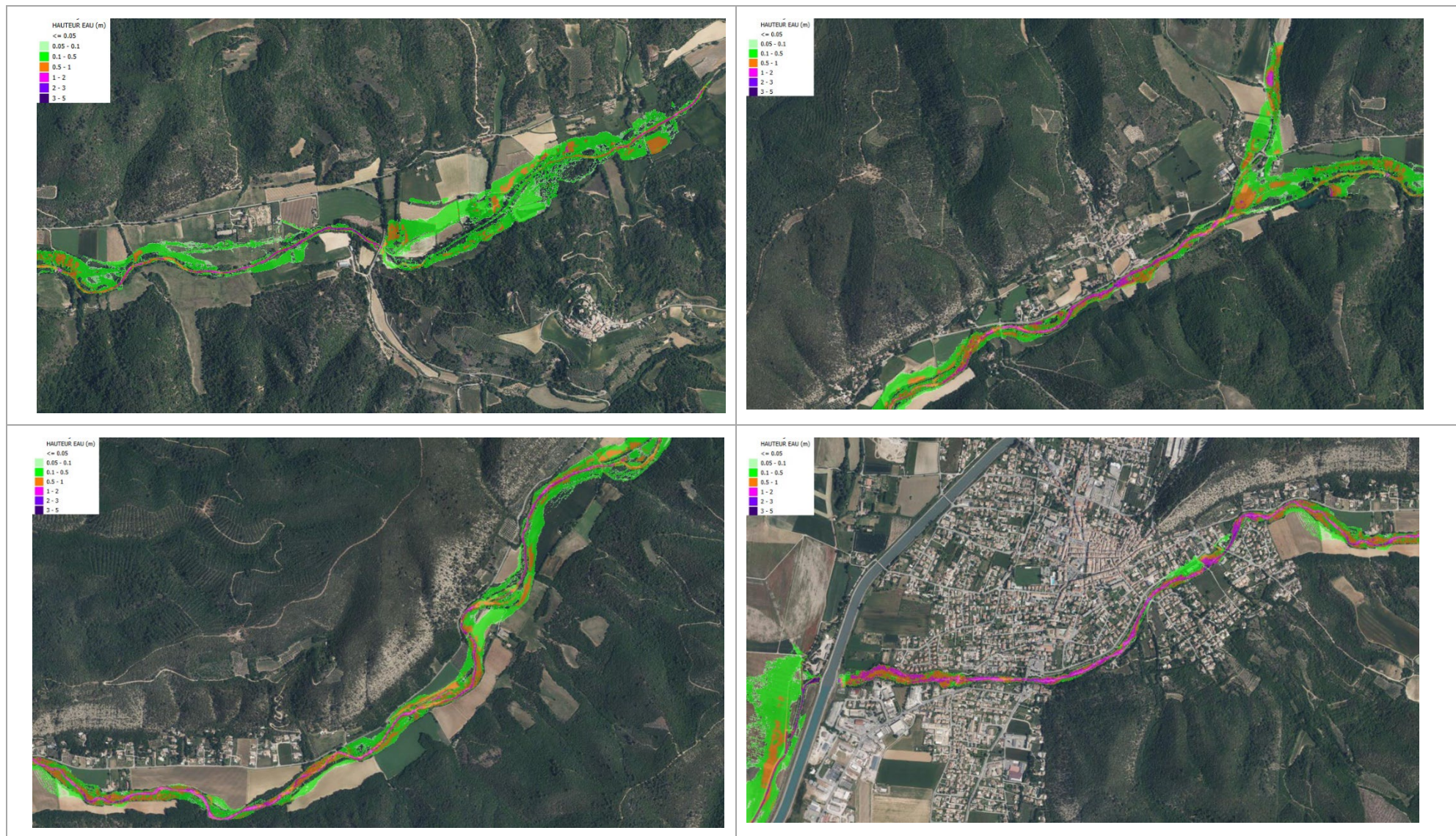
Figure 166 Cartographie des hauteurs d'eau pour la crue de novembre 2019 (forçage débit_AMC2_fonds actuel) : secteur en amont du gué de la route d'Entrevennes (haut_gauche), secteur de Castellet (haut_droite), secteur de la ferme Bondil (bas_gauche), traversée d'Oraison (bas_droite)
