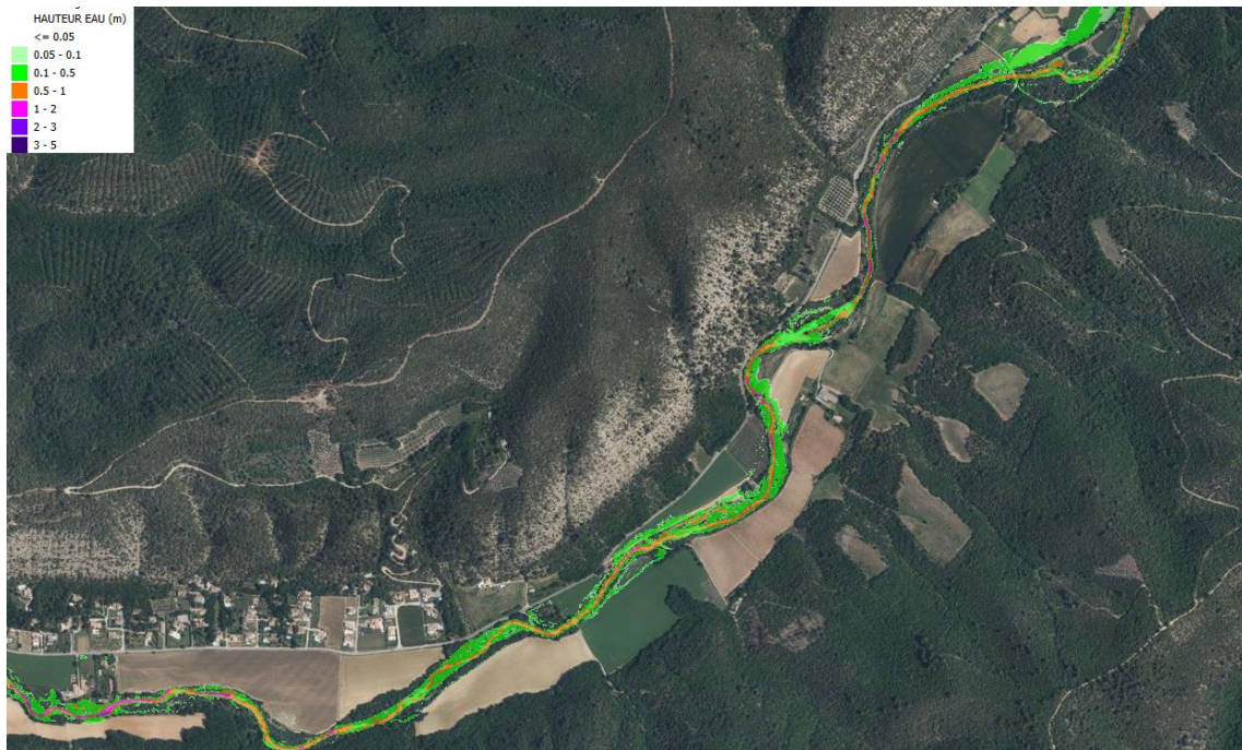
Figure 198 : Cartographie des hauteurs d'eau pour la crue de janvier 2014 (forçage débit_AMC2) : secteur de la ferme Bondil
