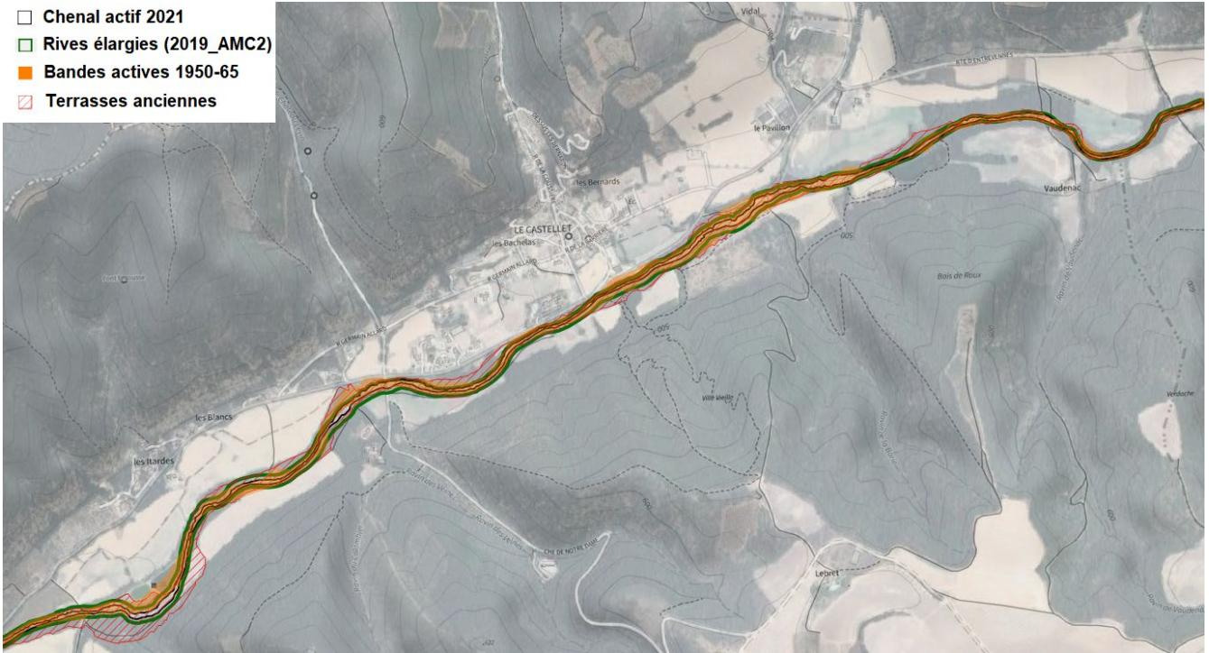
Figure 214 : Élargissement médian simulé du chenal actif (crue 2019_AMC2) : secteur du Castellet
