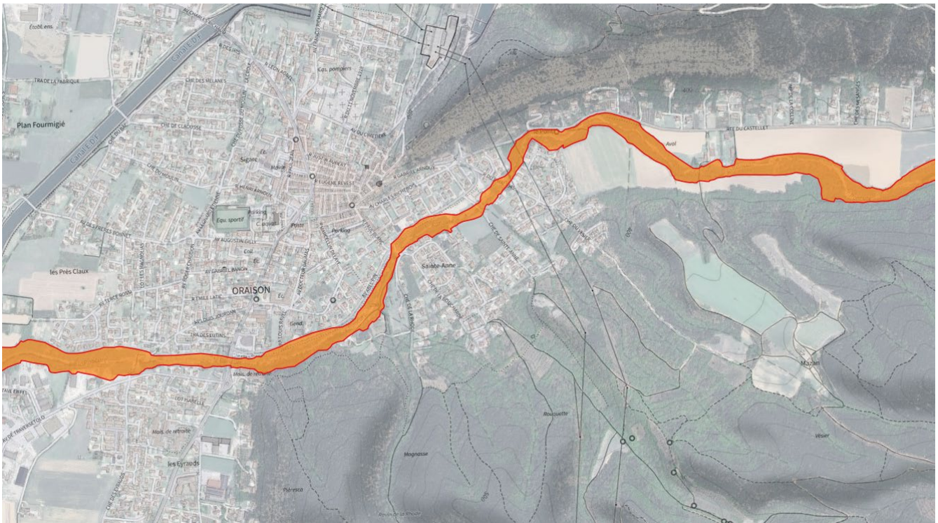
Figure 210 : Corridor de mobilité historique (Union bande active 1950–65 ∪ terrasses anciennes) : secteur de la traversée d'Oraison
