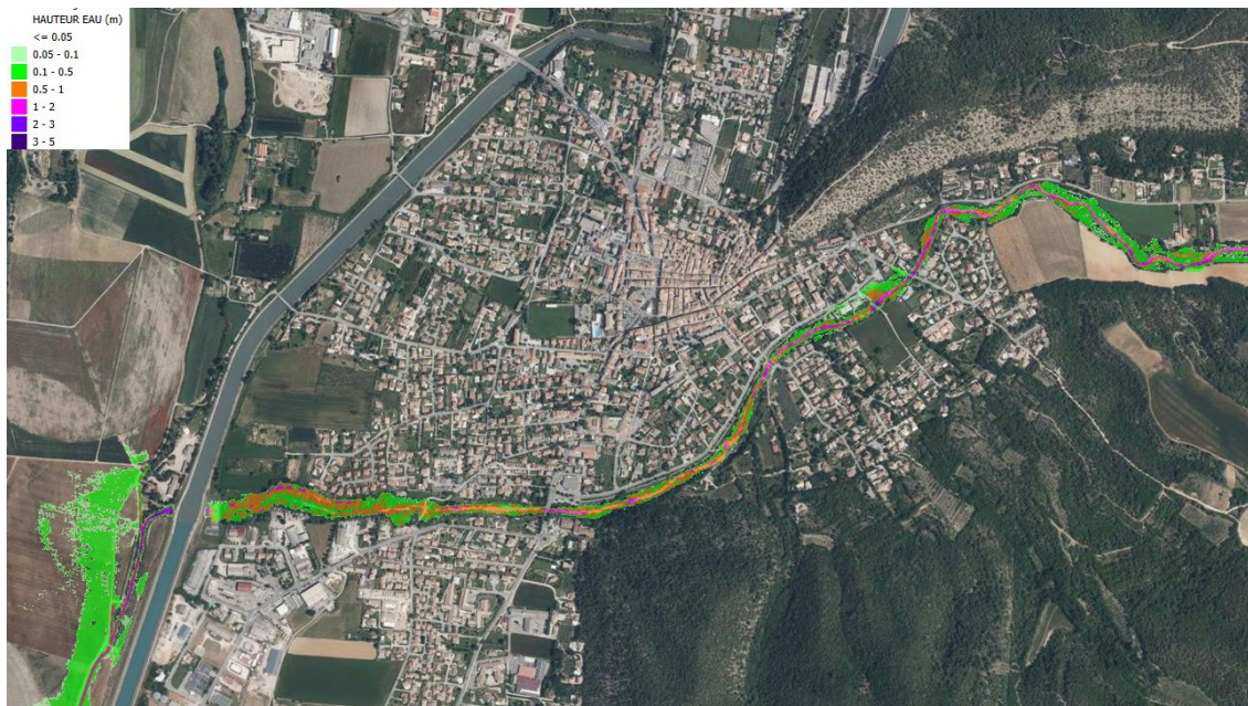
Figure 195 : Cartographie des hauteurs d'eau pour la crue d'août 1998 (forçage débit_AMC2) : secteur de la traversée d'Oraison
