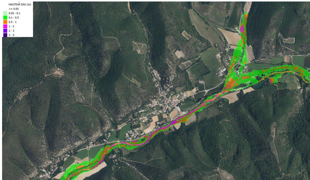
Figure 205 : Cartographie des hauteurs d'eau pour la crue de novembre 2019 (forçage débit_AMC2) : secteur du Castellet
